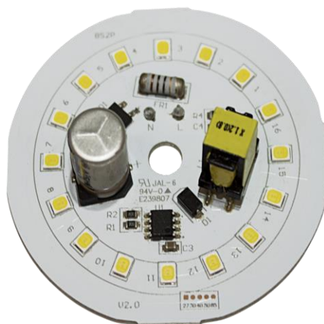
Foto 1: Exemplo de solução 15W LED com CI, com 12 componentes, não isolado.
